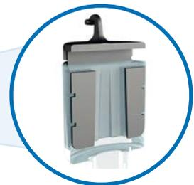
Zwei-Wege-Entlüftungsprinzip: Abgeschiedene Luft strömt definiert über die zentrale Bohrung im Schwimmer ab, ohne Wasser mitzureißen.
