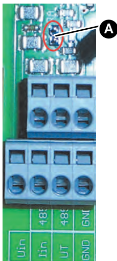
Figura 12: Attivazione della resistenza di terminazione
