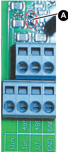
Abbildung 12: Aktivierung des Abschlusswiderstands
