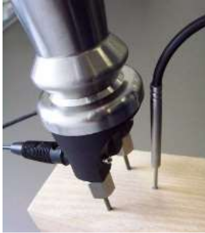
Bild 3: Beispiel Hohlhammerelektrode mit Temperaturfühler
