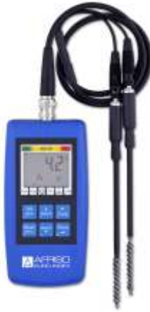
Bild 3: Messung mit Bürstenelektroden
